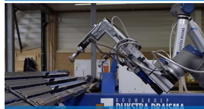
robotisering gevel- en dakelementen
