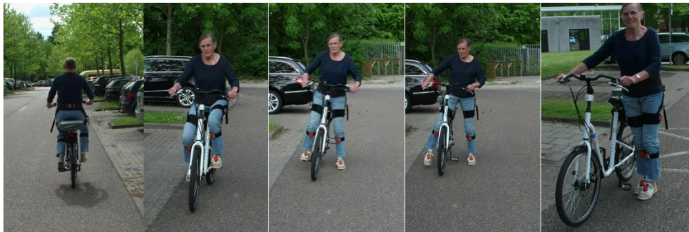
Figuur 2. Het opstappen op SOFIE fiets: doorstappen frame, zitten op zadel, één voet op pedaal en trappen, langzaam neemt zadelhoogte toe.
