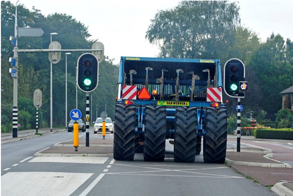
Figuur 4 Spitmachine van 3,50 m breedte
