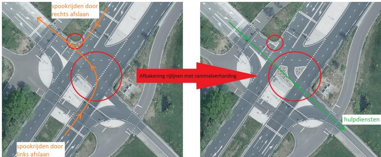
Figuur 2. Voorbeeld van toepassing van de afbakening van rijlijnen in een bestaande situatie (haarlemmermeeraansluiting). De middengeleider wordt doorgetrokken tot de rijcurve. Door gebruik te maken van bijv. basaltblokken blijft de doorgaande manoeuvre mogelijk voor hulpdiensten, maar is deze voor het overige verkeer niet comfortabel.
