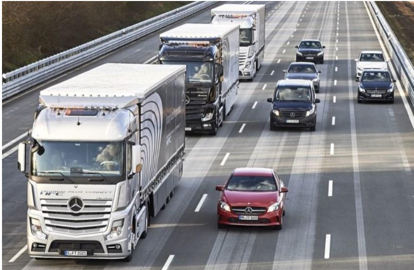
Figuur 2. Platooning in gebruik met 3 vrachtwagens op snelwegen.
