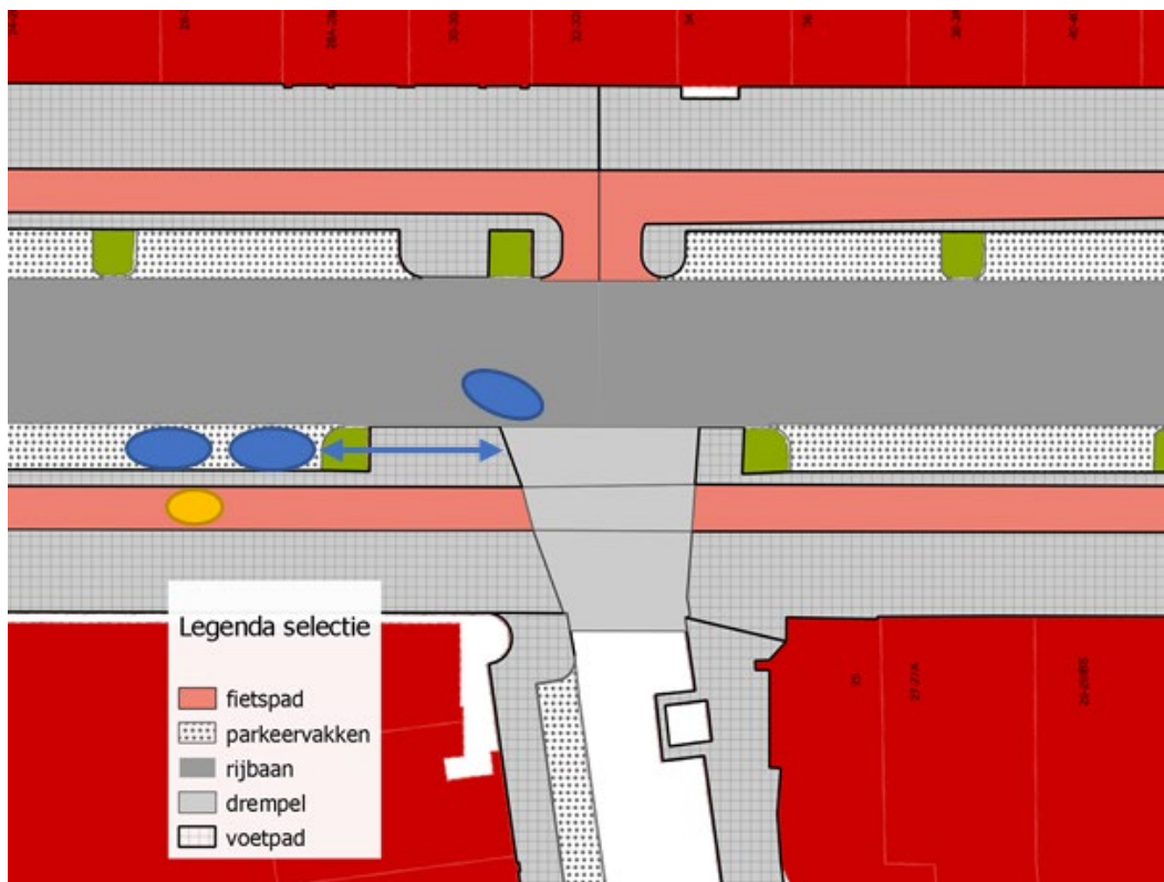
Figuur 1 Situatieschets van een 3-taks GOW-ETW-kruispunt met fietspaden
